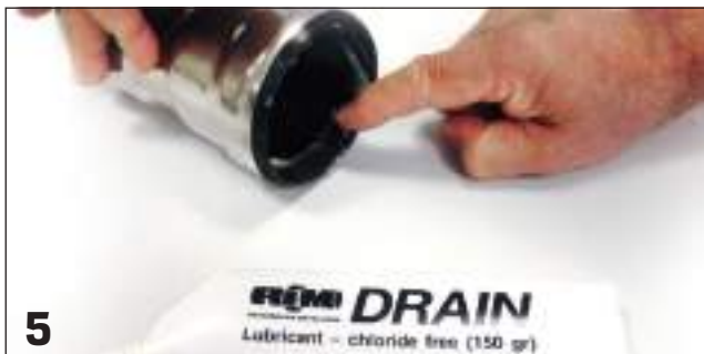
5 Lubrificazione zona interna guarnizione / Internal gasket lubrication
